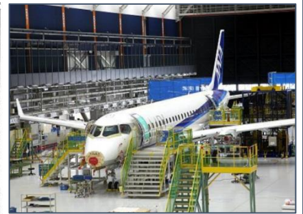
『MRJ 組み立て工場』
